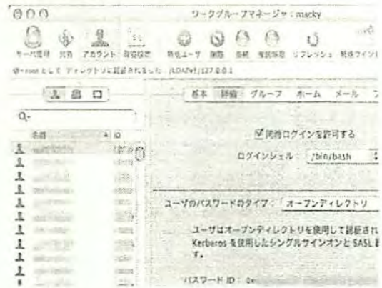
Fig.2 LDAP+Kerberos 認証 OSXserver のユーザー管理画面
